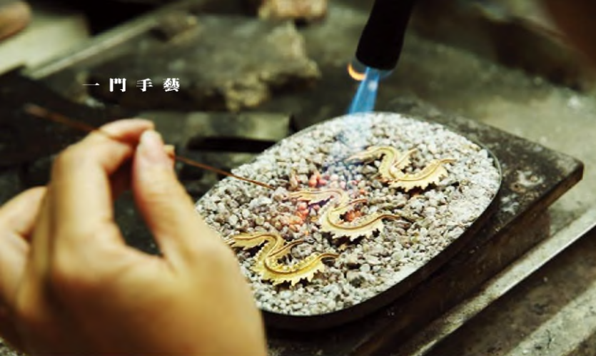
在耐火石上用火槍燒黏各個零件（左圖），組裝完成精細的龍（右圖）之後，還得送廠電鍍才算完成。
