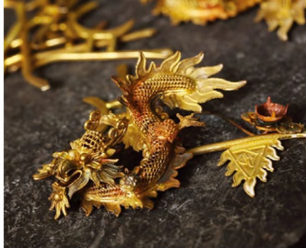
在耐火石上用火槍燒黏各個零件（左圖），組裝完成精細的龍（右圖）之後，還得送廠電鍍才算完成。
