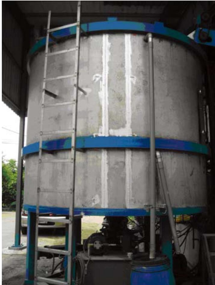
● 圖17 直立圓桶密閉式醱酵槽
