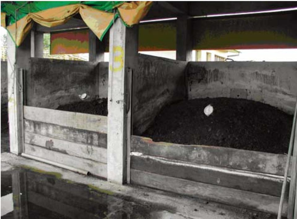
● 圖9 箱型堆肥舍醱酵槽
