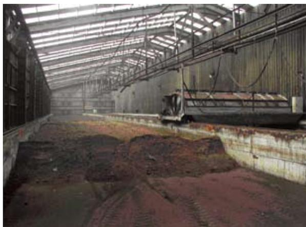
● 圖14 刀爪式攪拌混合操作
