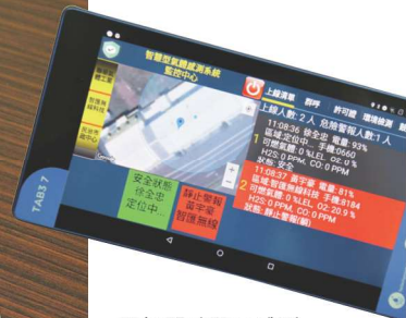
平板即時顯示感測器數據和狀況。
