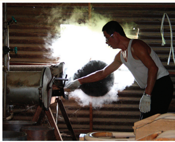
煙霧瀰漫中，師傅從蒸汽鍋爐中取出軟化的藤條，準備在木模上彎曲做造型。
