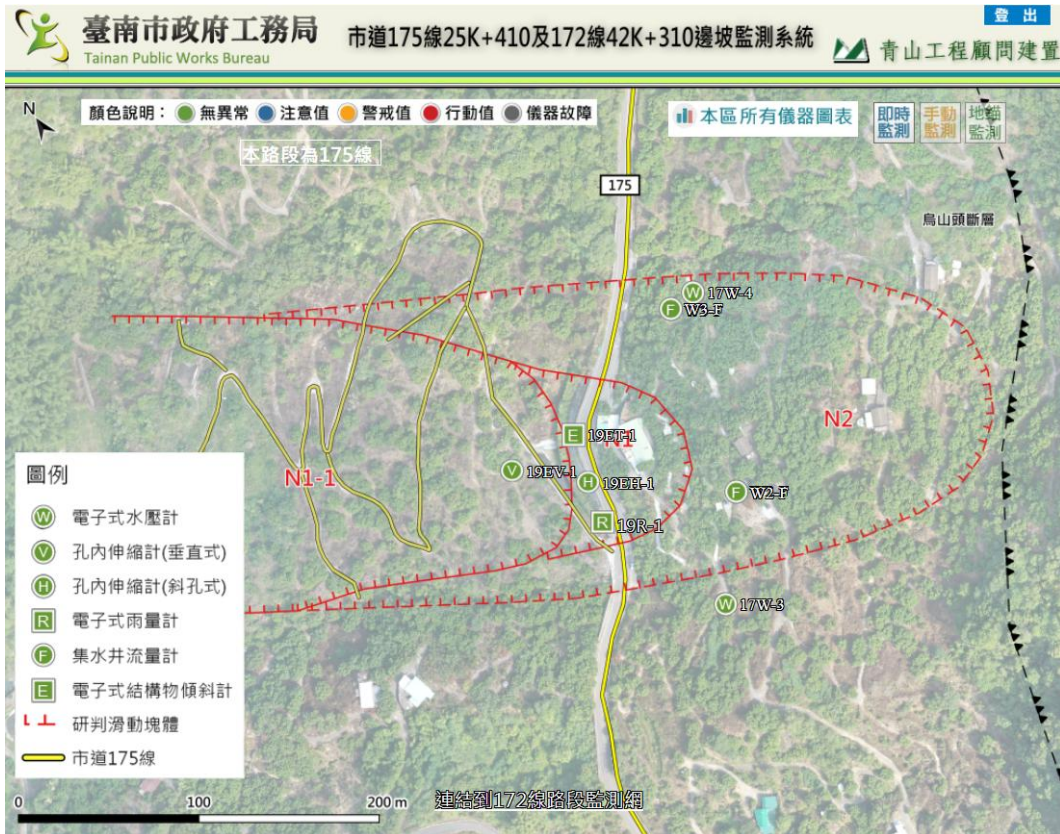
圖 3-2、175 線 25K+410 路段自動化預警系統網頁
