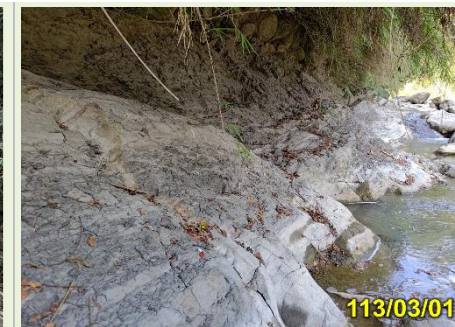
I 邊坡趾部可見岩層出露，多為泥岩及頁岩，層面位態約(N53°E,66°NW)
