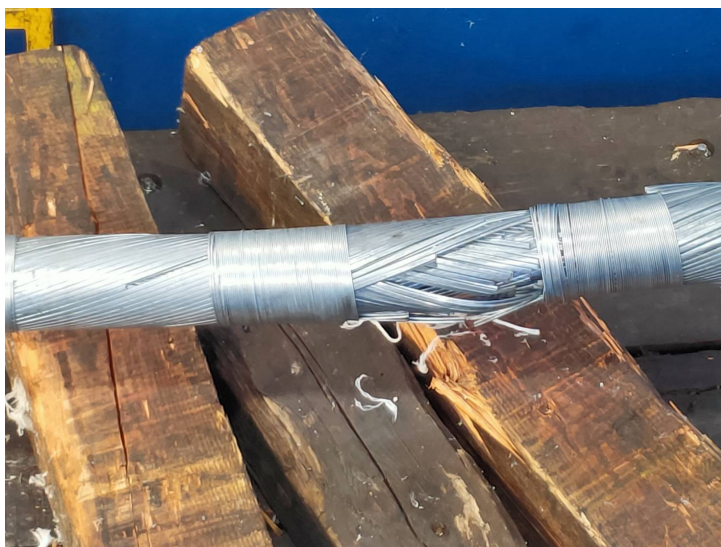
鋼纜拉力破壞情形
