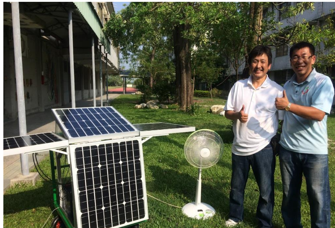
設置行動式再生能源發電車，可以提供穩定的110V交流電，將再生能源應用於低碳防災校園。【太康國小】
