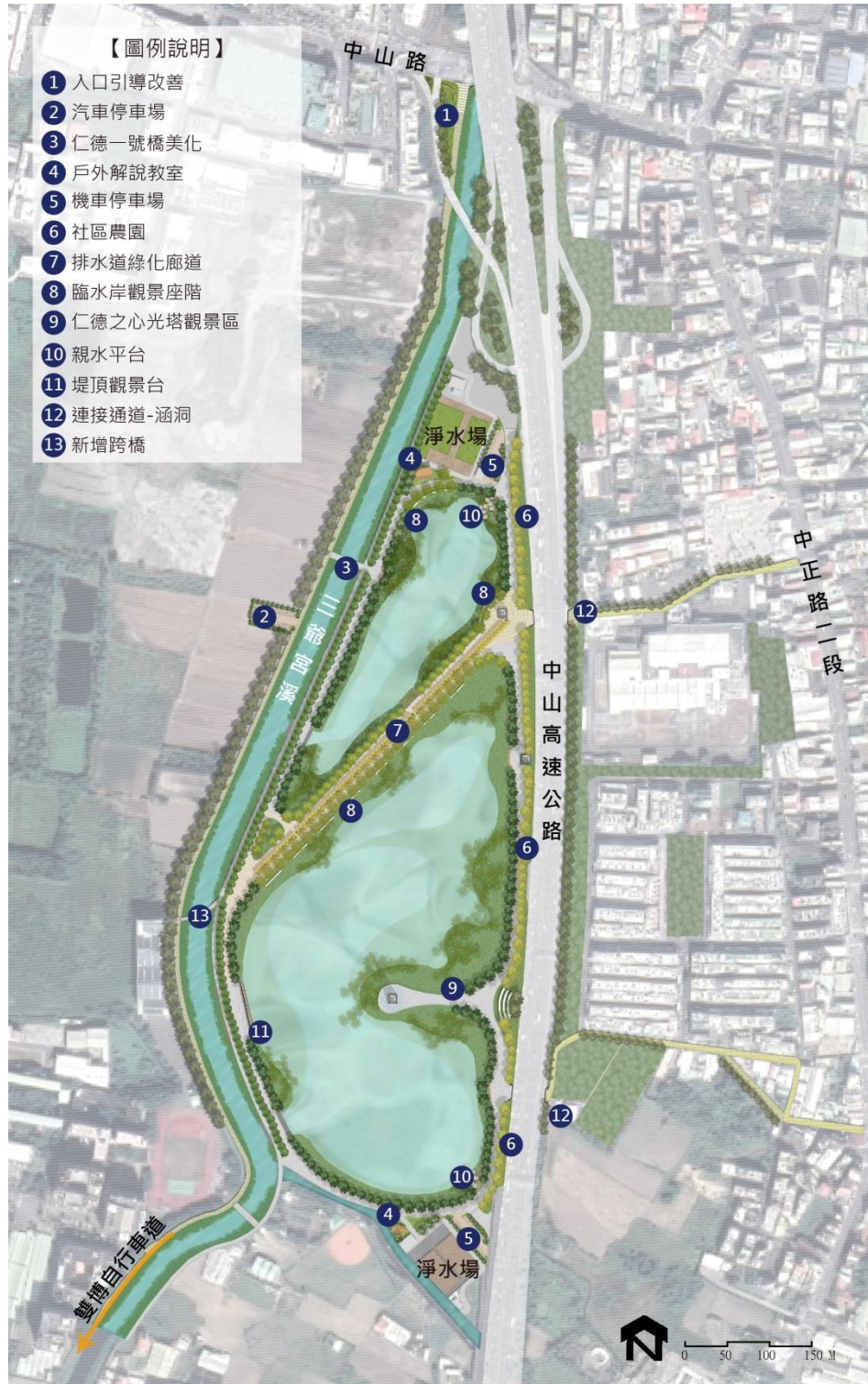
圖 4-3 仁德滯洪池平面配置圖
