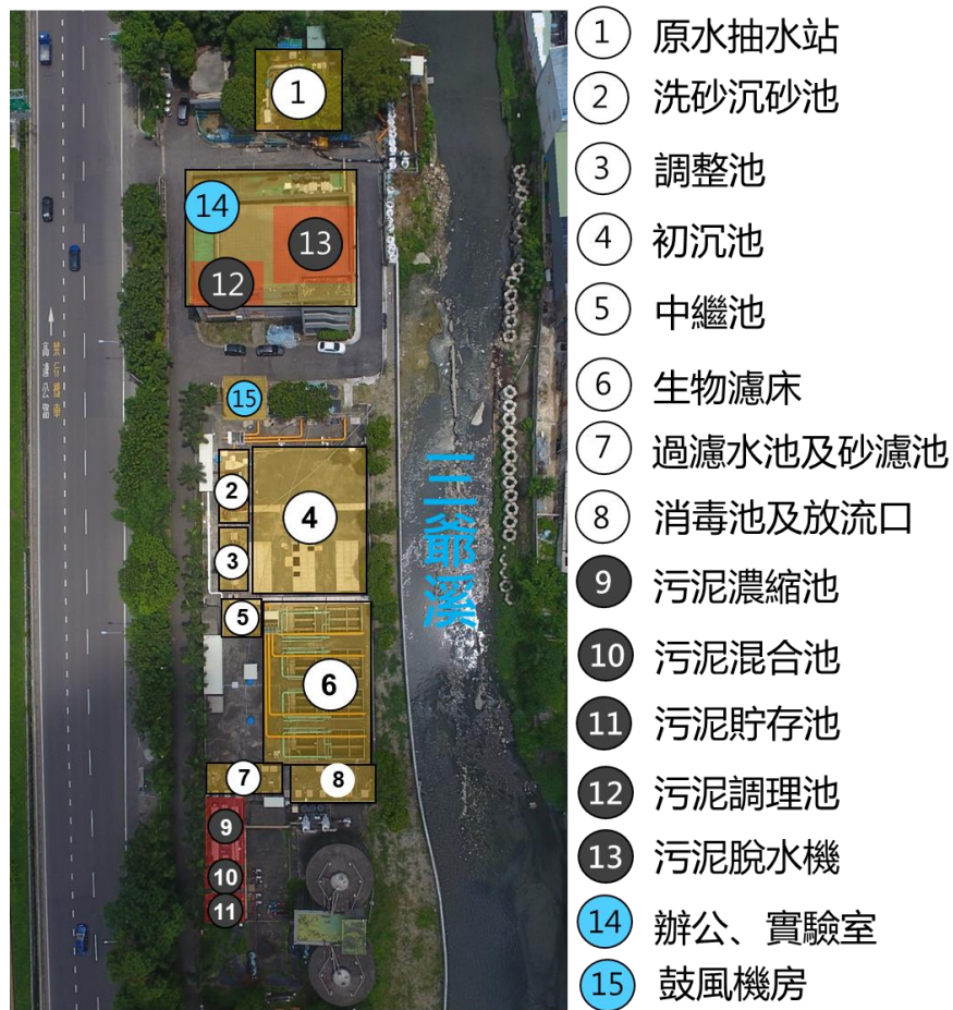
圖 2-1 虎尾寮水資源回收中心平面配置圖
