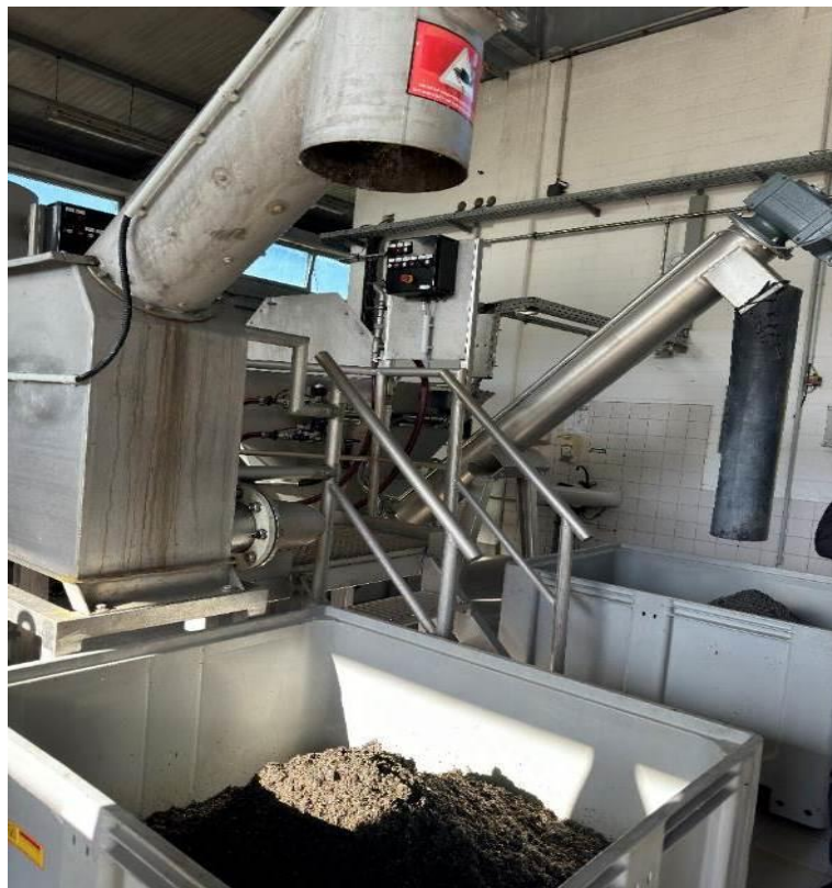
圖二、2-3. 洗砂機砂 15%含水率，回收再利用
