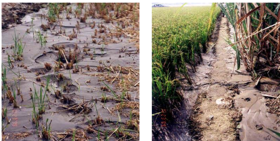
台南市後壁區菁寮里某稻田中成串之噴砂孔
