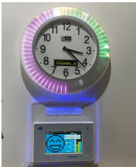
外層用顏色表示用電是否超標的時鐘顯示器
