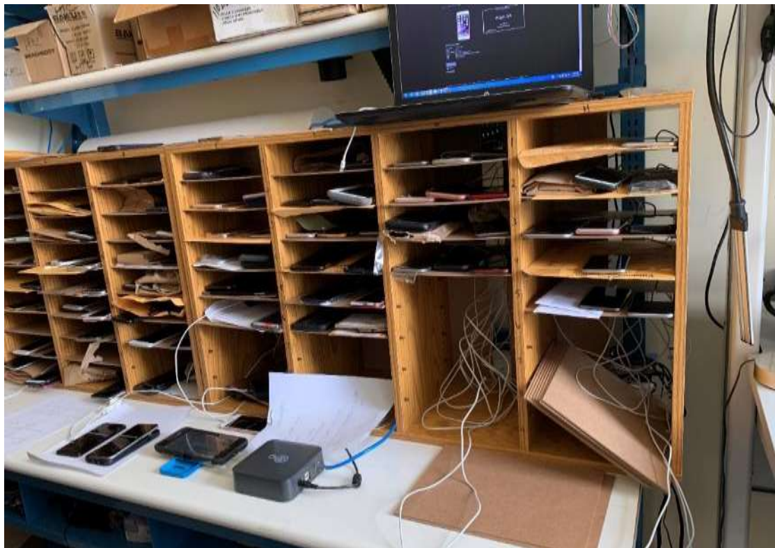
圖 85: Graykey 設備與待鑑驗手機，該收案櫃以品牌來區分置放處，且該局使用 Cellebrite 來破解 Android 安卓系統手機，使用 Graykey 來破解 Iphone 手機密碼
