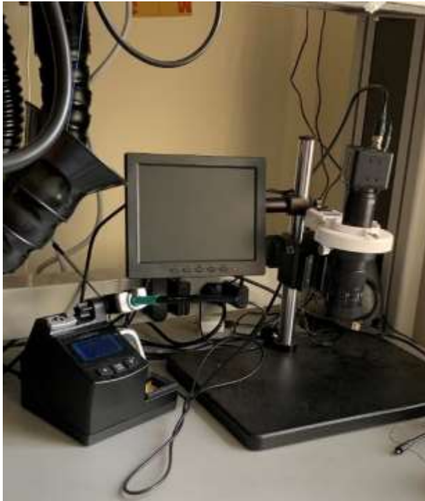
圖 83、84:電子顯微鏡與 BAKU 702B 焊接站，可焊接維修手機主機板等物
