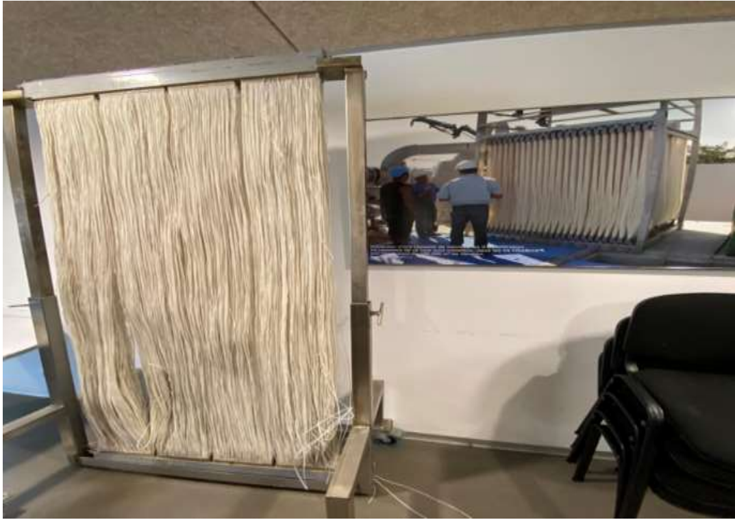
圖33 Aquaviva 污水處理廠 UF 纖維膜
