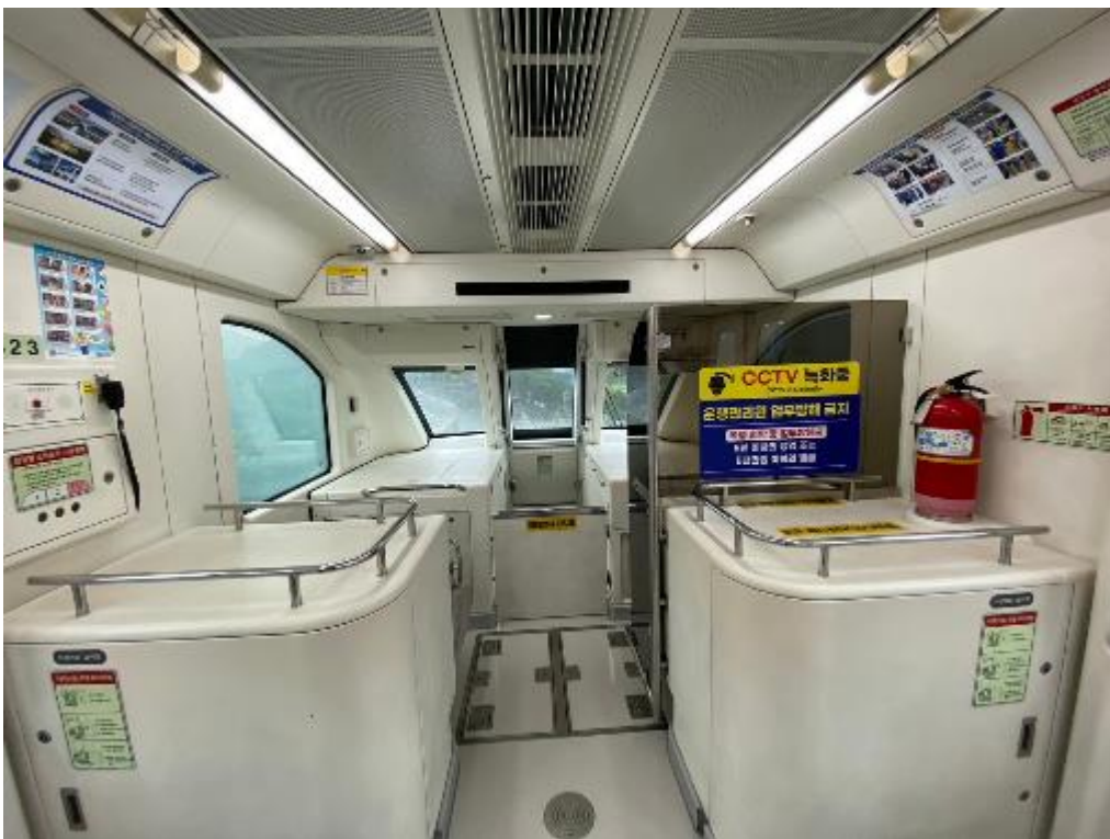
圖 41：列車駕駛臺周邊全貌(兩旁設有逃生設施)
