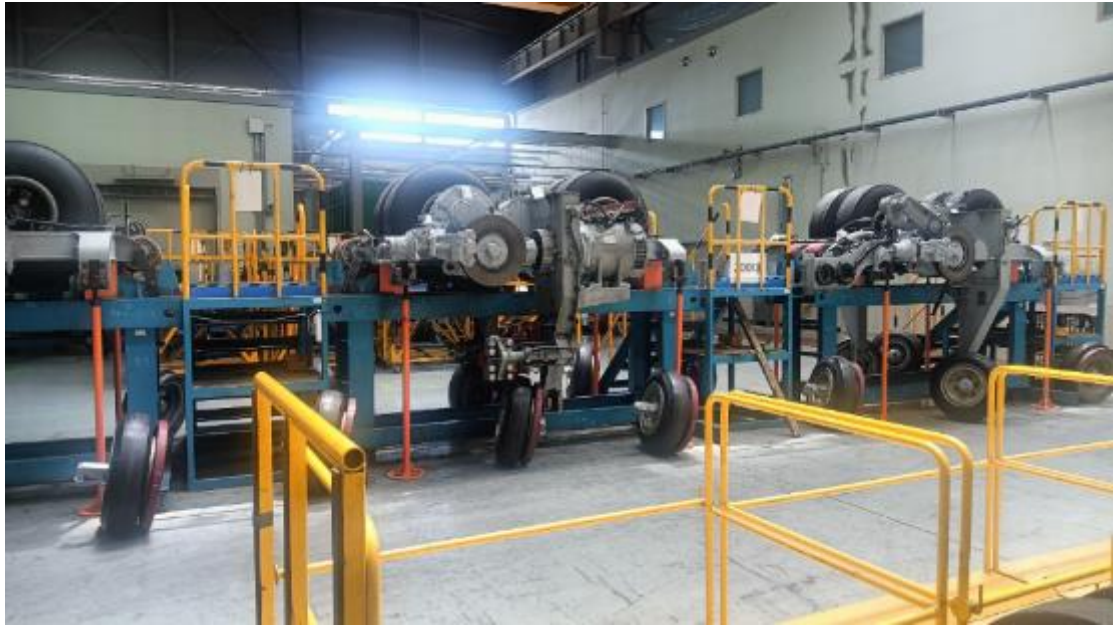
圖 26：機廠內擺設檢修使用之轉向架
