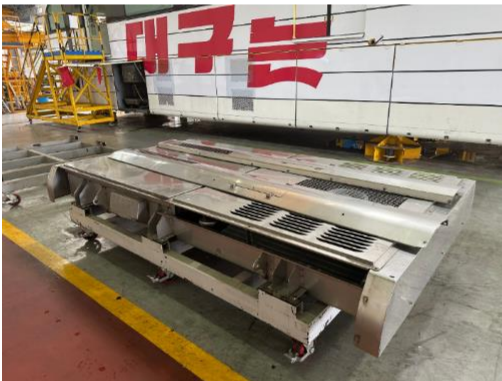
圖 28：DTRO 機廠維修人員進行空調設備更換作業
