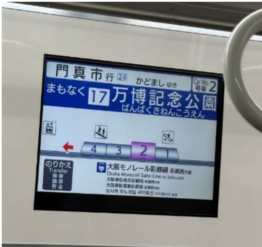
圖 66：清楚標示車廂位置與周遭電梯與電扶梯相對位置
