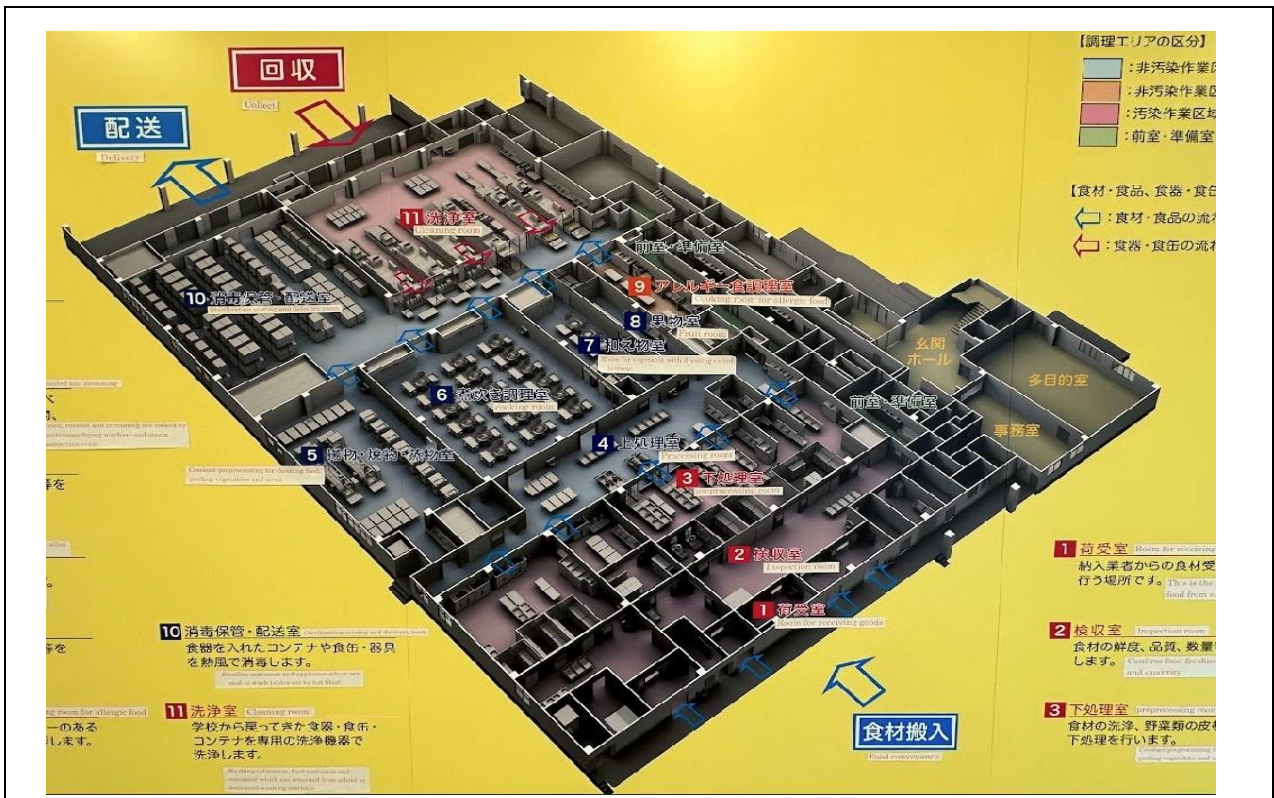
整個廠區分區以地板顏色做區分，人流、物流動線也規畫得很清楚。
