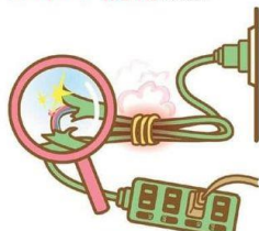
電線 不 綑綁折損
