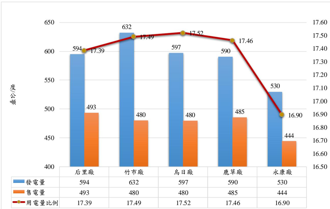
圖 4.3-9 后里廠等五座廠近 5 年每噸廢棄物發電量、售電量及用電量比例統計
