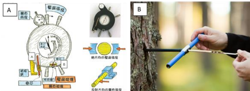
圖 13 微破壞儀與生長錐及其使用情形 (A)微破壞儀、(B)生長錐
