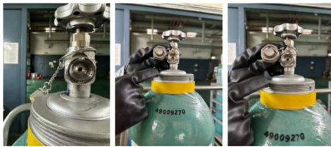
20230816 16:33 F2 閥凸緣與墊片外觀檢查 無殘留氣體與腐蝕跡象
