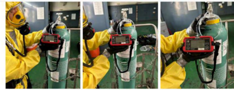
20230816 16:35 F2 閥出口測漏 Oppm 測試時間120sec
