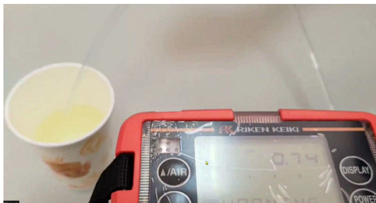
影片為模擬漂白水(含氯氣成份)使用 F2 感應器偵測其反應觸發警報
