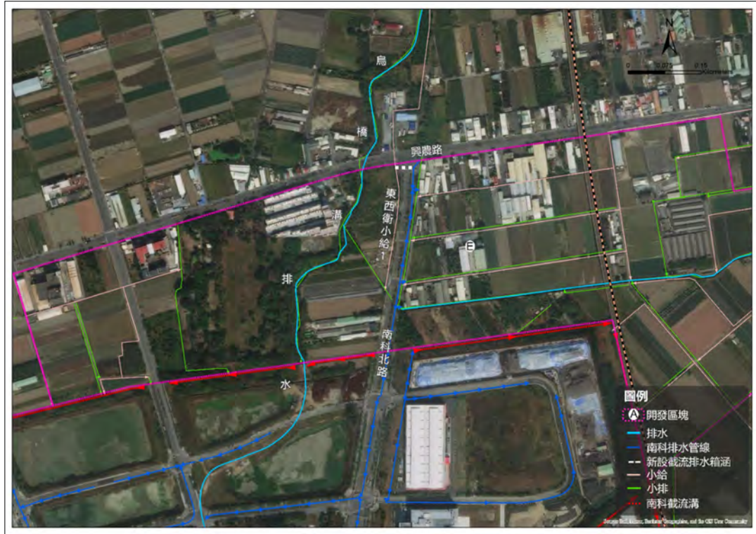
圖 44 東西衛小給 1 新設截流建議路線示意圖
