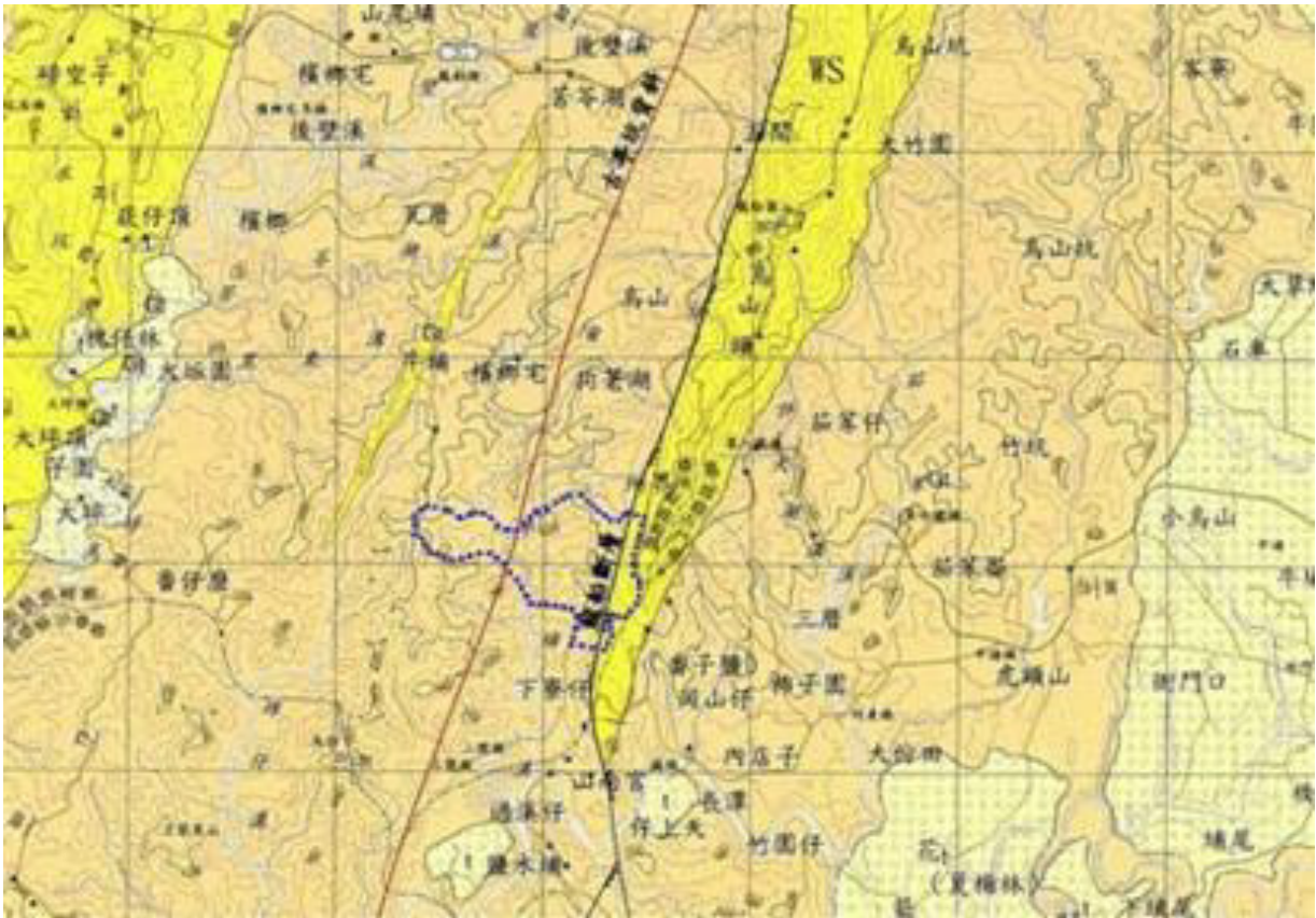
圖 2：龍崎牛埔工業區有龍船背斜與龍船斷層通過（黃煥彰，2016/8/8 看守臺灣）
