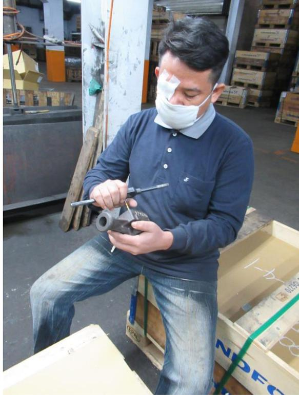
說明：罹災者勞工模擬使用施工扳手固定攻牙鑽頭從事零件內牙攻牙作業受傷現場情形。
