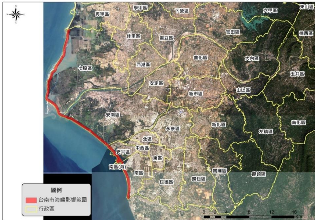
圖 1-3-3-20 臺南市溢淹範圍於地震發生後 90 分鐘(破裂帶 A1)
