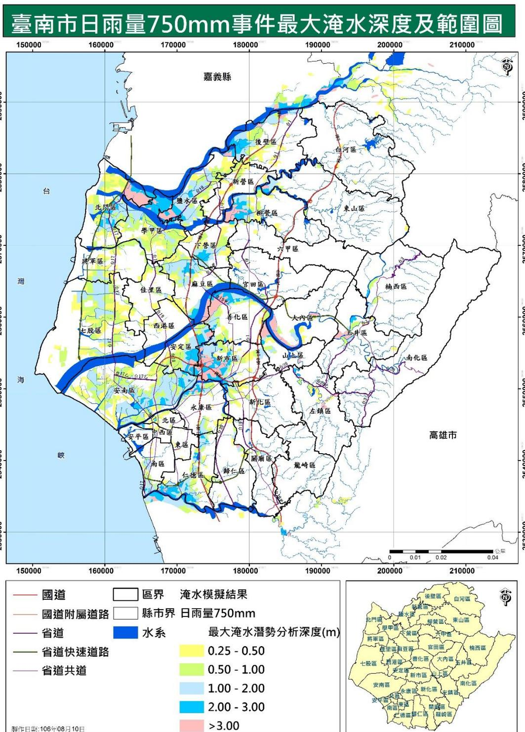
圖 3-1-1-20 模擬日雨量 750 毫米事件之最大淹水深度及範圍圖
