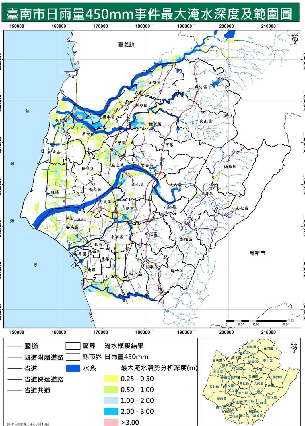
圖 3-1-1-18 模擬日雨量 450 毫米事件之最大淹水深度及範圍圖
