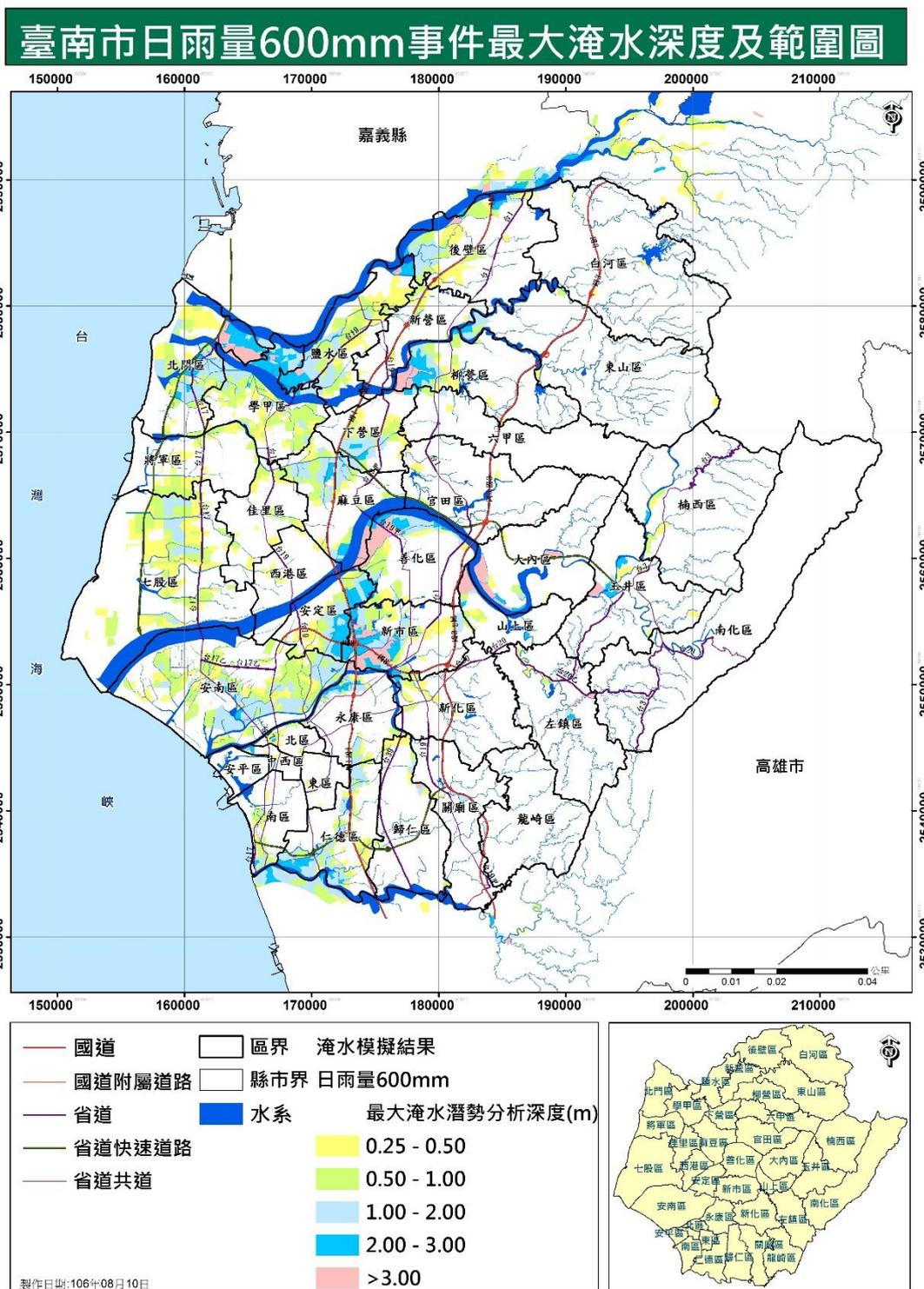
圖 3-1-1-19 模擬日雨量 600 毫米事件之最大淹水深度及範圍圖
