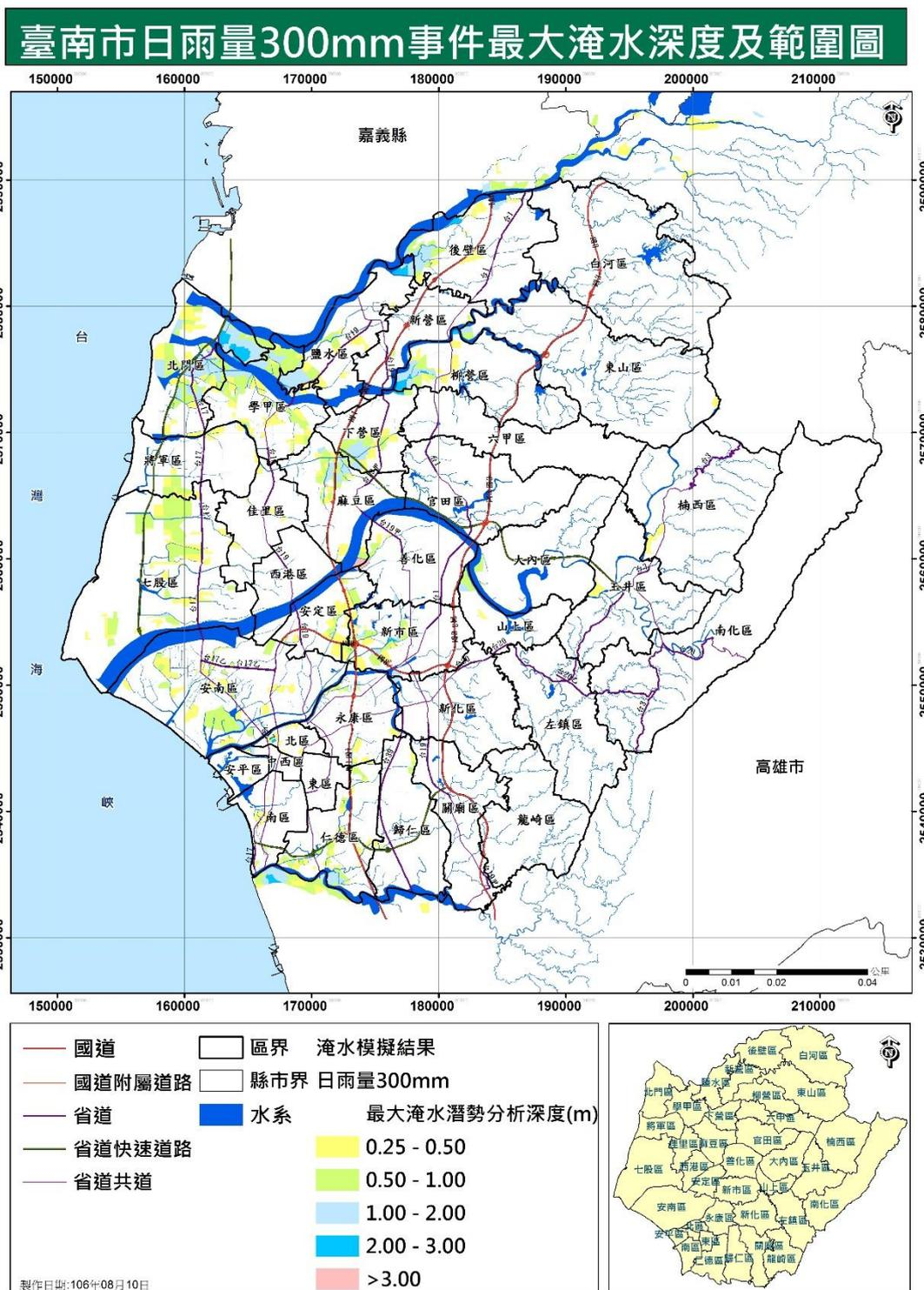
圖 3-1-1-17 模擬日雨量 300 毫米事件之最大淹水深度及範圍圖
