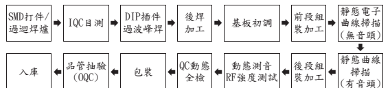
圖3-7 無線麥克風發射機生產流程圖
