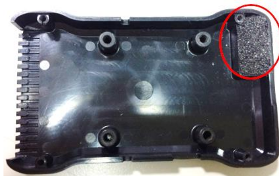
圖 4.10 原始飛控板外殼加裝海棉示意圖
