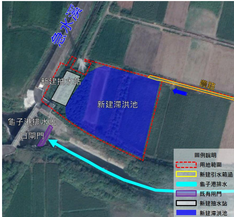
圖 3 八老爺滯洪池及應急抽水站平面示意圖
