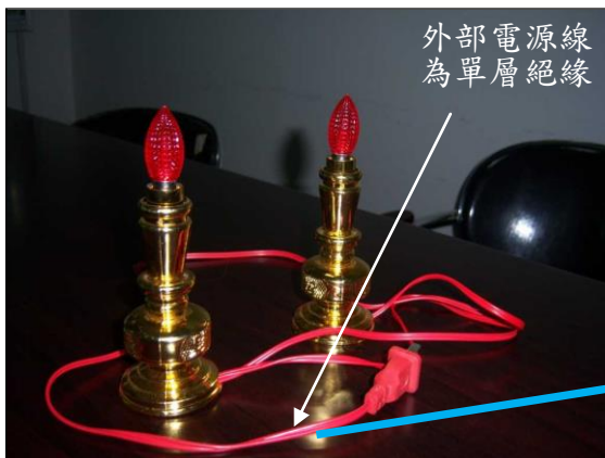
(a) 神明燈電源線組(不合格例)
