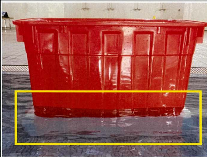
附圖二：測試中樣品照片(浮力、吸水性試驗)
