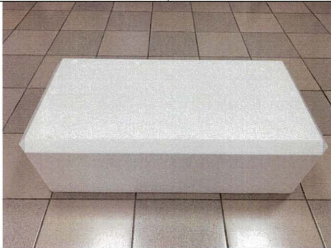
附圖二：測試中樣品照片(浮力、吸水性試驗)
