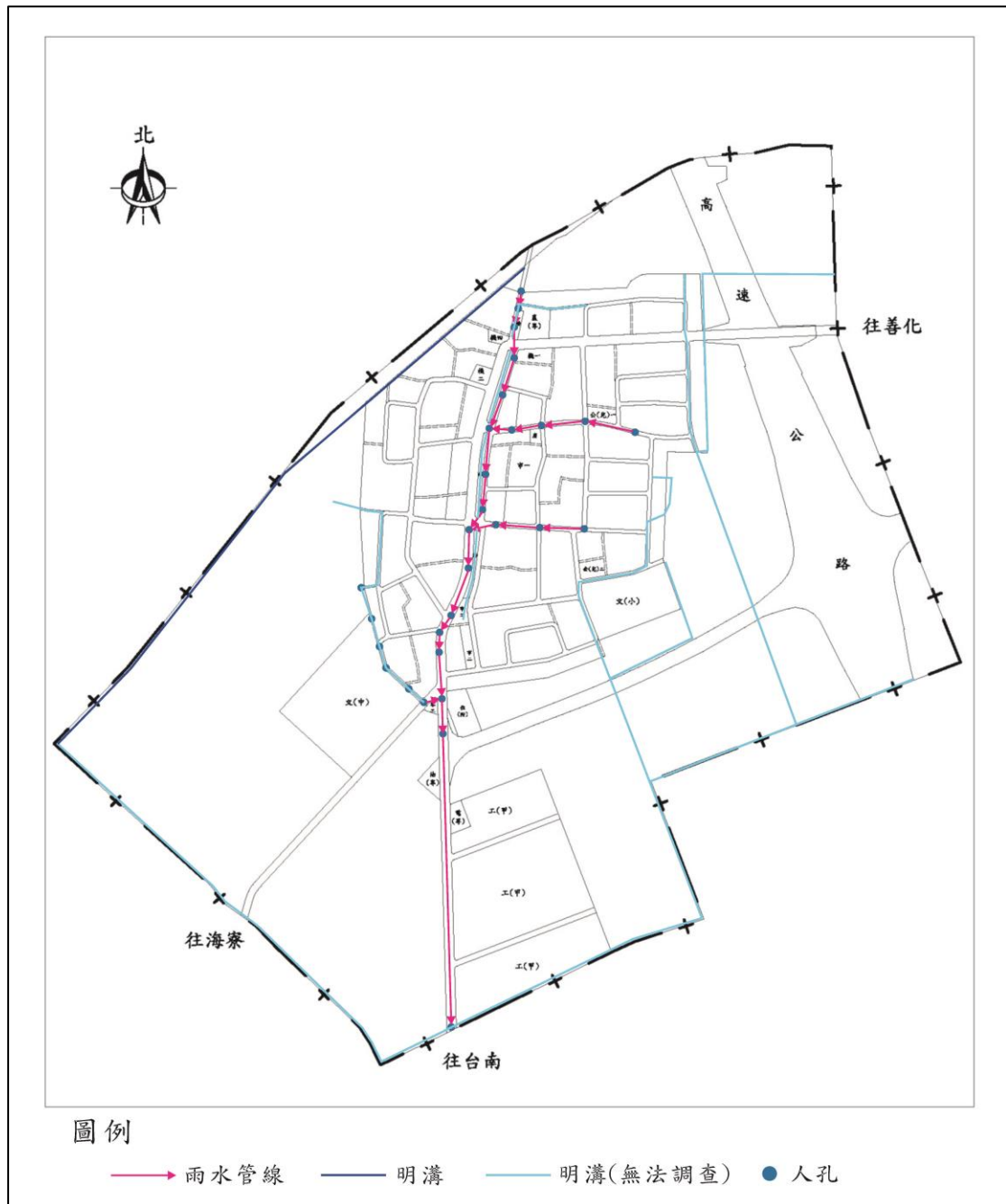
圖 3-16 安定區雨水下水道設施示意圖
