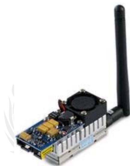
圖3.6 影音發射機(5.8GHz)
