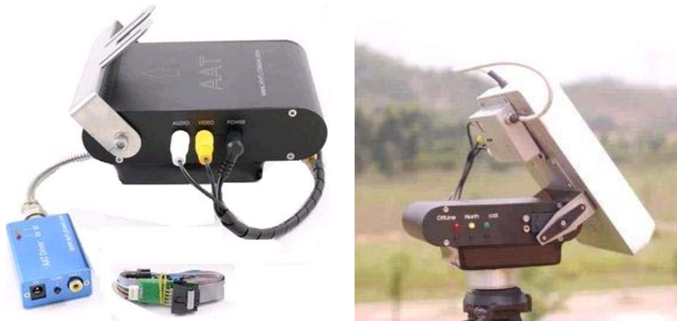
圖3.10 MyFlyDream AAT 自動追蹤雲台系統[32]
