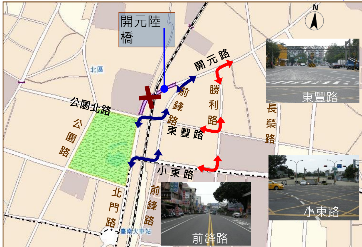
開元陸橋封閉車輛改道動線
