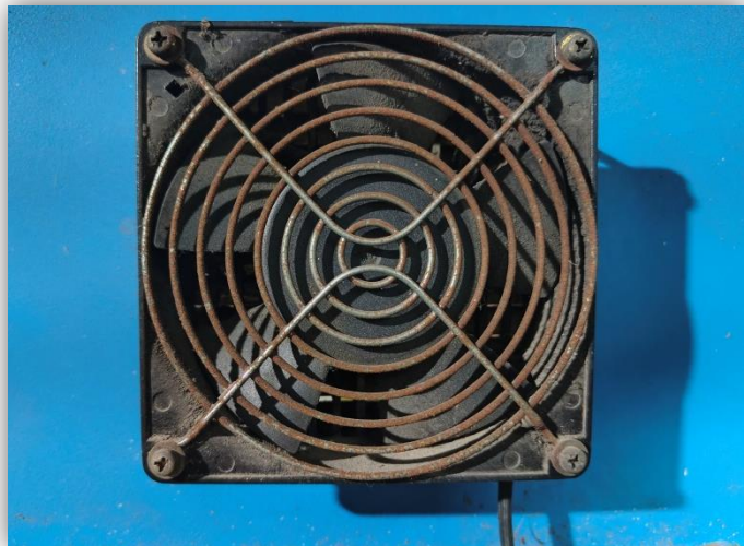
改善前以風扇散熱粉塵易入侵
