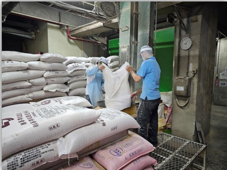
人力割袋投料作業
