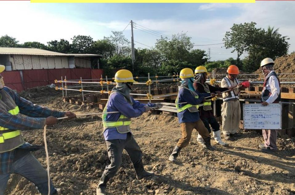
護欄拉力測試
