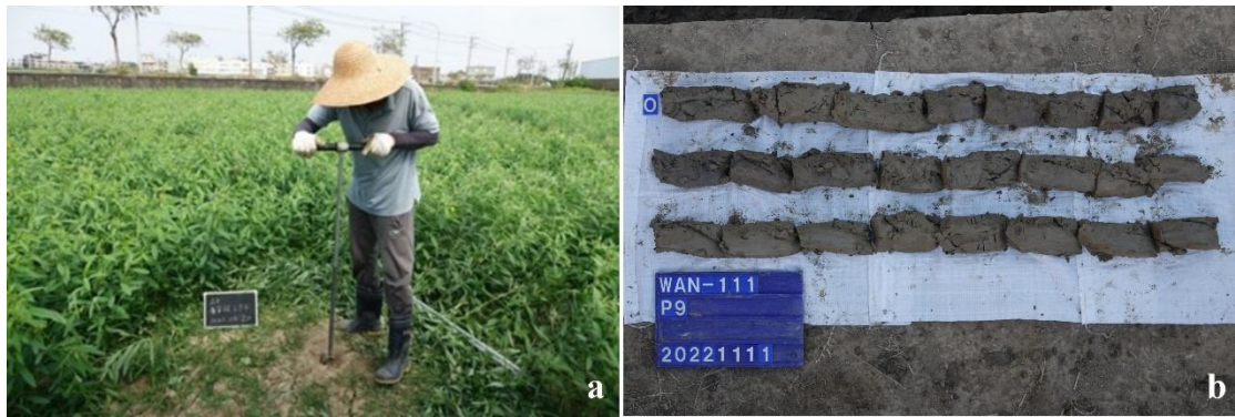
圖 3：人工鑽探工作照（a.工作同仁進行人工鑽探作業。b.人工鑽探取出土芯紀錄照。）
