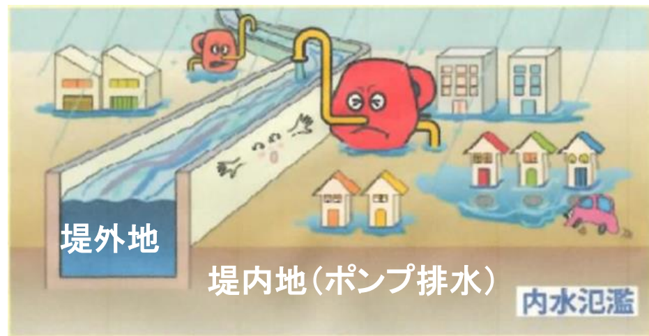
(堤内側に降った雨による)内水氾濫
