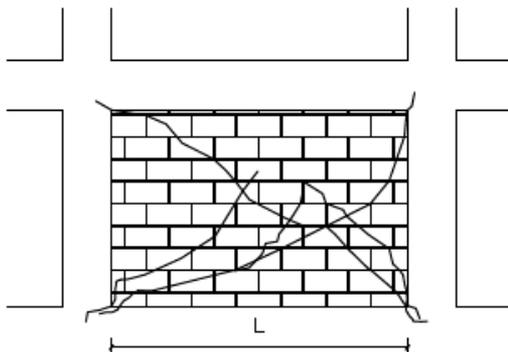
斜向裂縫(可能沿磚縫處開裂)
