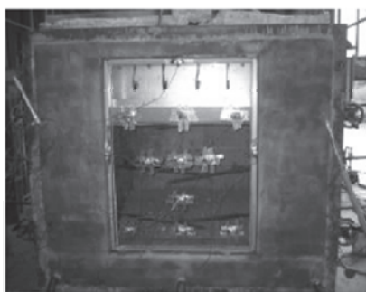
(a) 含水膜之一般強化玻璃性能實驗整體配置圖
