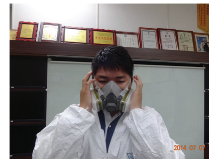
5. 進行氣密測試-負壓測試
