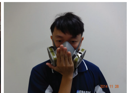
6. 進行氣密測試-正壓測試
