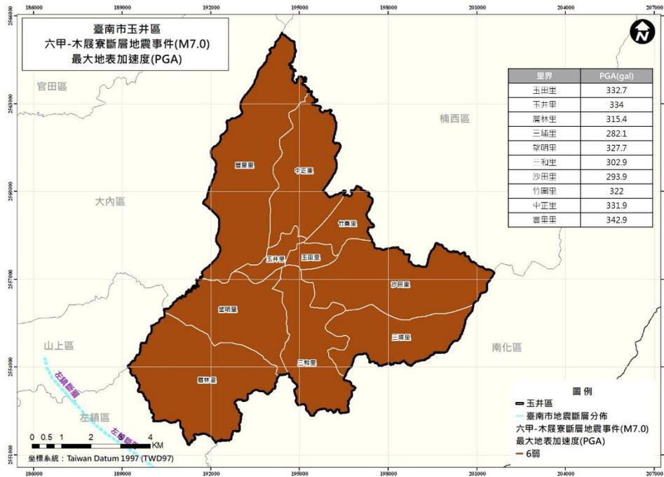
圖 6-2-5 臺南市玉井區最大地表加速度 (PGA) 分布圖
