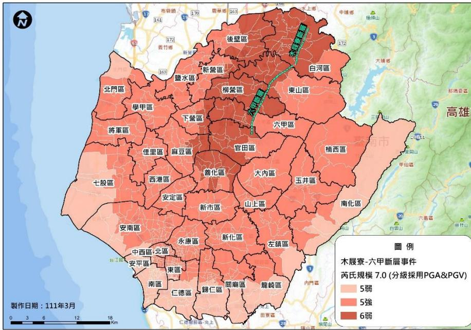
圖 6-2-4 木屨寮-六甲系統斷層地震最大地表加速度(PGA)分布圖
