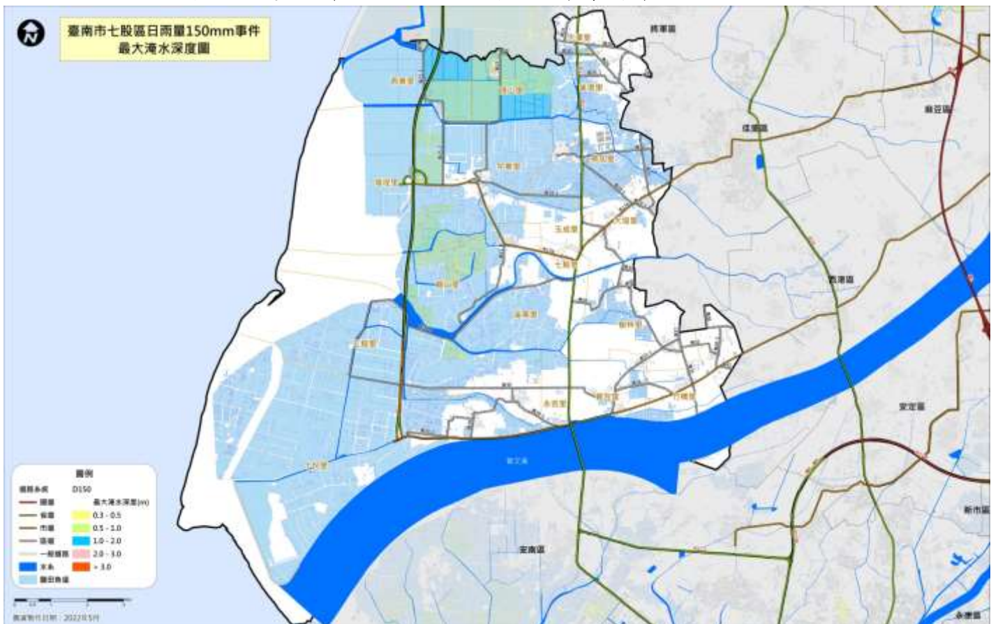
圖 2-2-3 臺南市七股區日雨量 150mm 事件最大淹水深度圖
