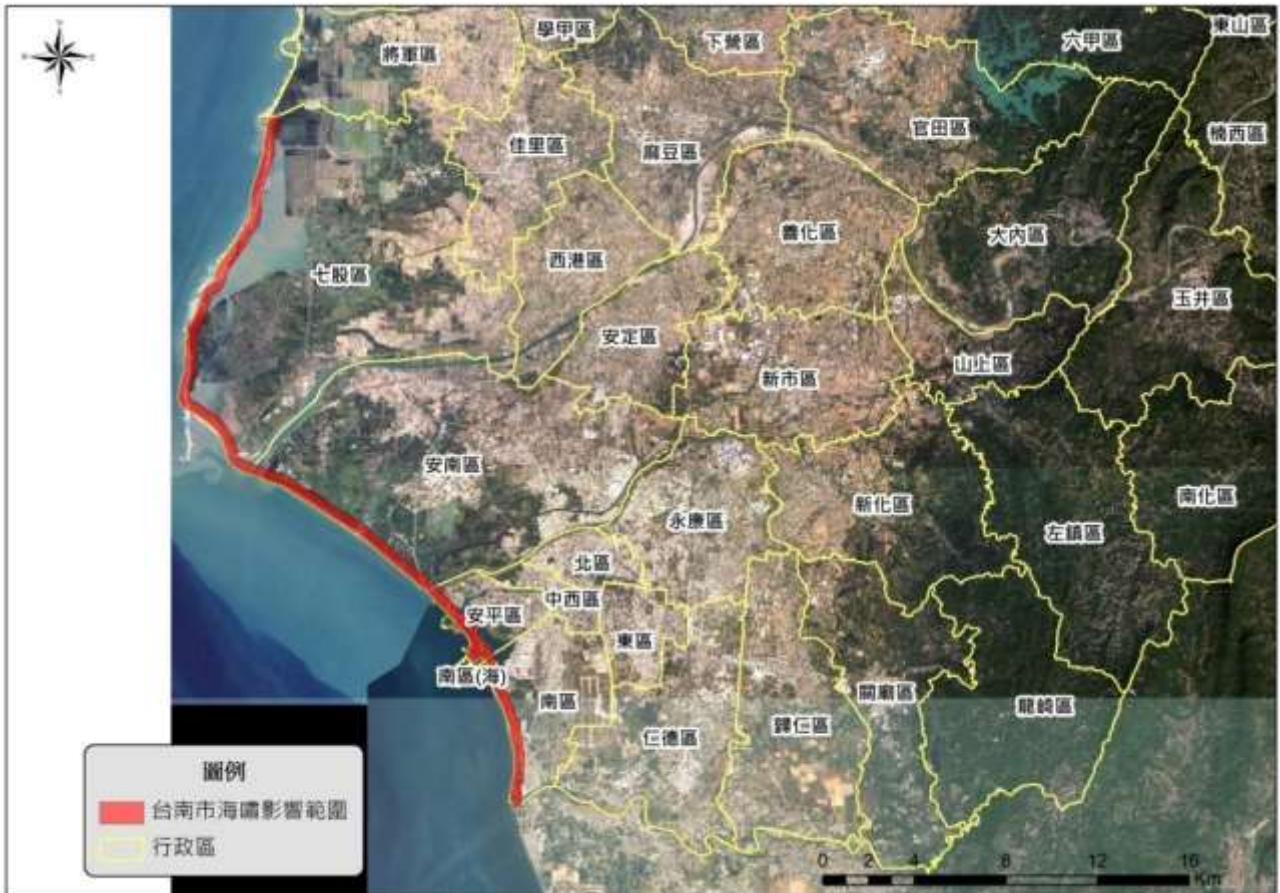
圖2-2-18臺南市溢淹範圍於地震發生後90分鐘(破裂帶A1)
