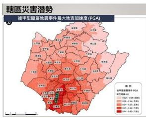
圖 2-2-4(b)後甲里斷層帶地震事件最大地表加速度 PGA
