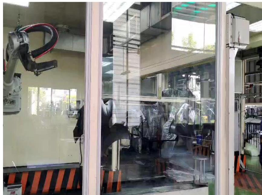
塗裝機械手臂外圍設置安全光閘，防護人員遭機械手臂撞傷
