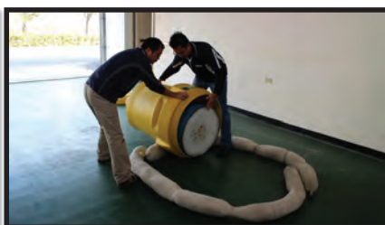
5. 將95加侖回收桶壓至倒在地 (注意人員腳部安全)。
