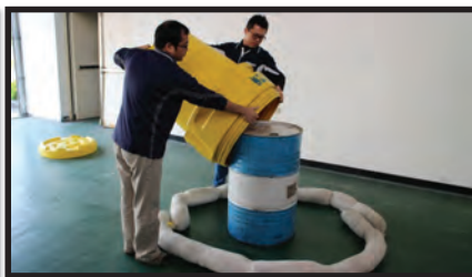
2. 將95加侖回收桶向下，蓋進55加侖鐵桶內。
