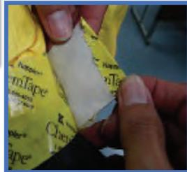
纏繞時以手腳彎曲方式纏繞抗化膠帶以利後續應變作業
