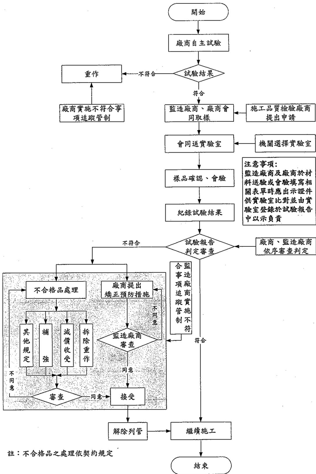
圖 8 瀝青混凝土施工流程參考圖
