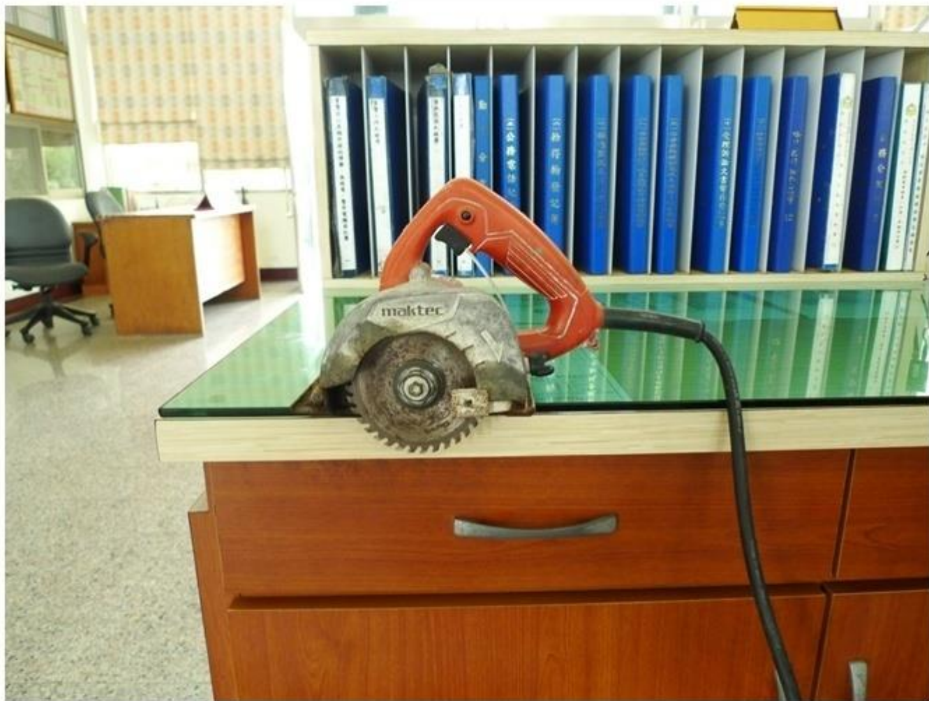
照片四：(四) 罹災者(自營作業者)所使用之攜帶式圓盤鋸之鋸齒接觸預防裝置未具備可動式覆蓋、未具備平板。↵
