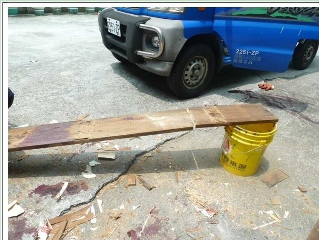
照片七：研判罹災者(自營作業者)欲將該廢棄木材切割數小塊以利清運，其切割時將廢棄木材倚靠在塑膠水桶(高36公分)上，使用攜帶式圓盤鋸進行切割(模擬狀況)。
