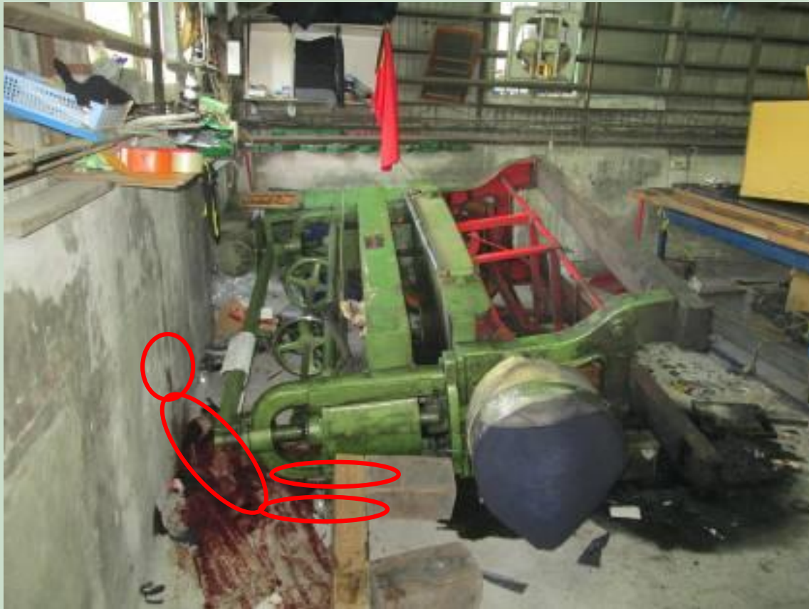
罹災者被翻倒之斬切機壓住頭胸部示意圖
