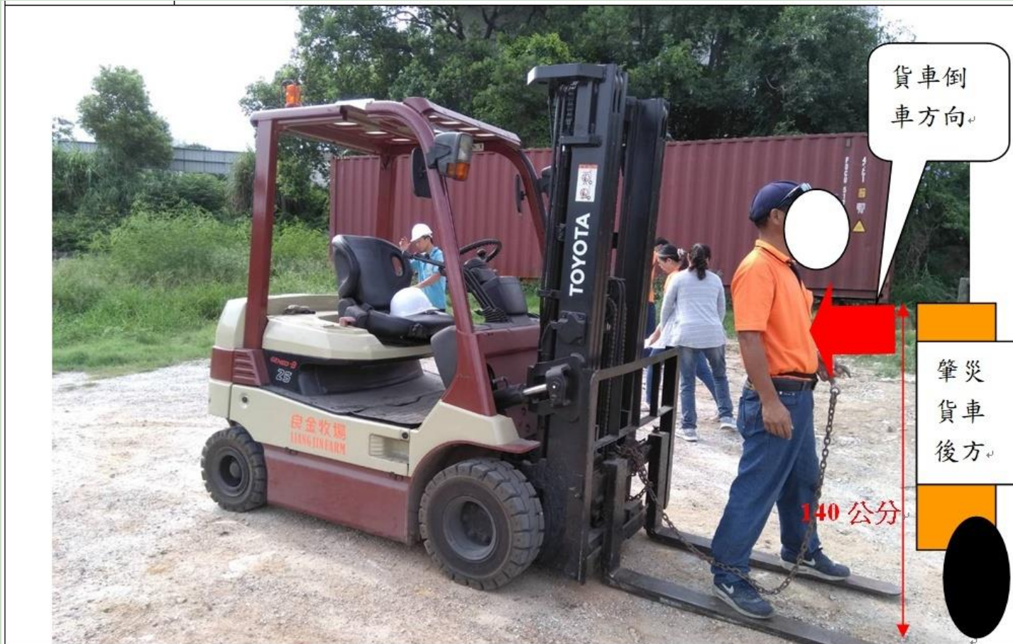
照片 7。罹災者欲繫掛鐵鍊至貨車時，貨車司機朱○未注意罹災者位置，仍持續倒車，使罹災者被撞擊並夾於後扶架與貨車升降尾門間。(模擬照)。
