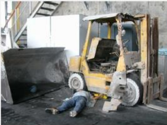
從事堆高機檢查維修作業發生被壓致死災害
