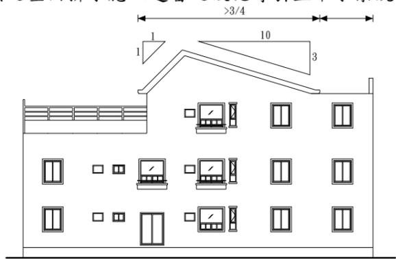
附圖 4 斜屋頂斜面坡度底高比示意圖
