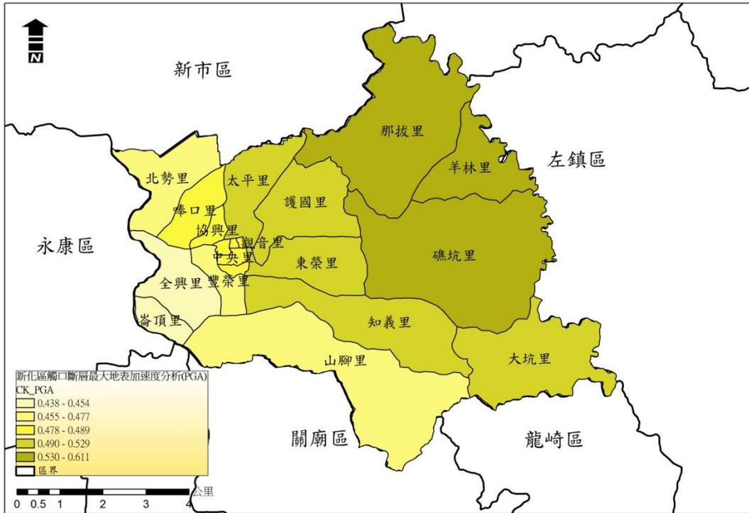
圖 3-1-2 觸口斷層地震事件新化區最大地表加速度分布圖
